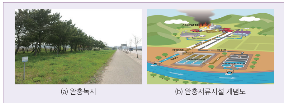
그림 III-5-19 화학물질 누출 피해저감을 위한 완충시설
